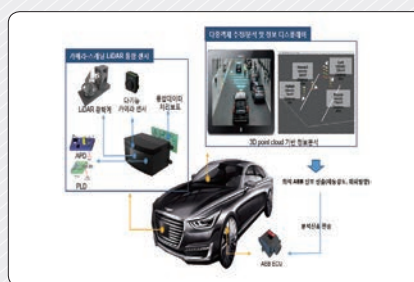
AEB용 라이다-카메라 융합센서 인지시스템
